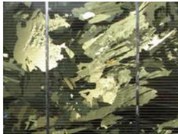
**Figure 7** : Cellule en silicium Poly-cristallin [7]
