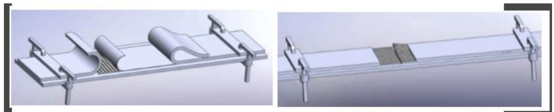
Jonctionnement à deux étagements
