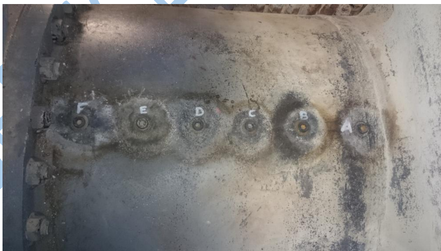
Figure 2 : Photo des points d'introduction de la caméra endoscopique 1
