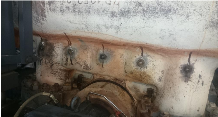
Figure 3 : Photo des points d'introduction de la caméra endoscopique 2
