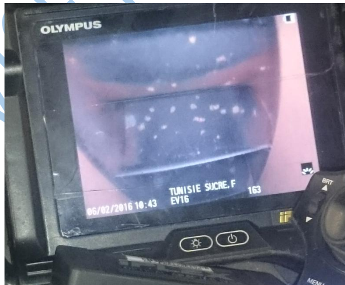
Figure 4 : Photo de tâches blanches de dépôt sur une ailette
