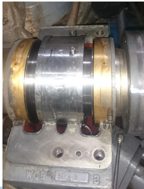
Figure 15 : Photo du palier sans capots
