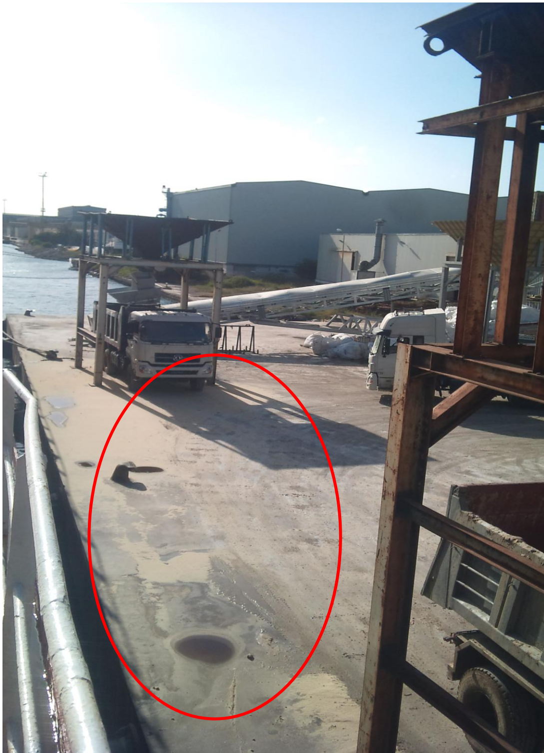
Figure 16 : manque des équipements de nettoyages de la sole
