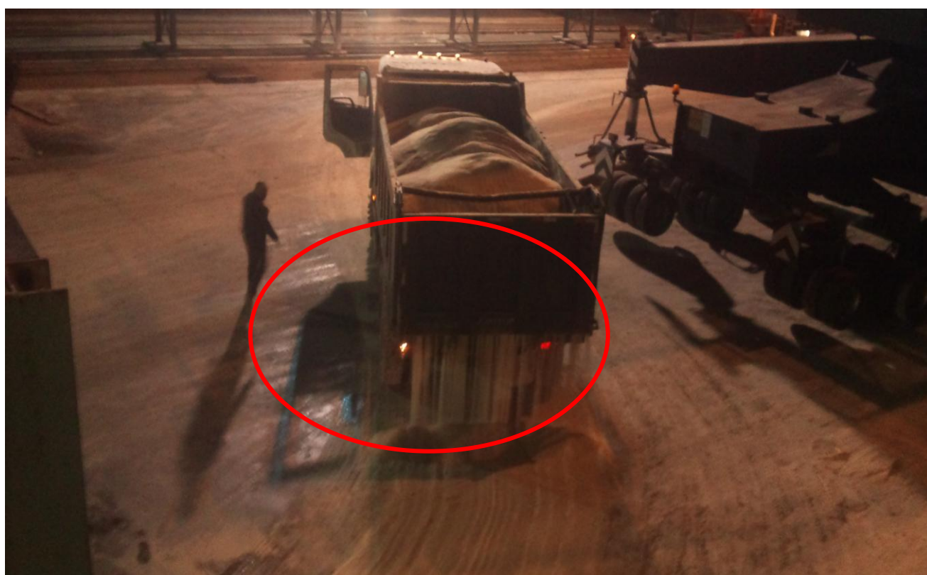
Figure 9 : benne des camions mallent fermée
